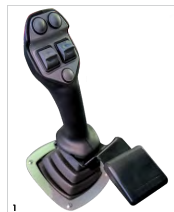
Der hydraulische, elektroproportionale Multifunktionsjoystick wird serienmäßig nur in den Versionen HLS, VPS und VPSe eingebaut.
