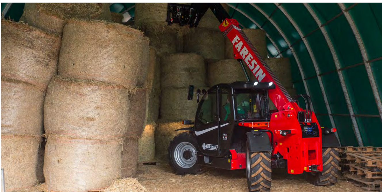
Krabbenlenkung zur seitlichen Annäherung und bei schwierigen Manövern
